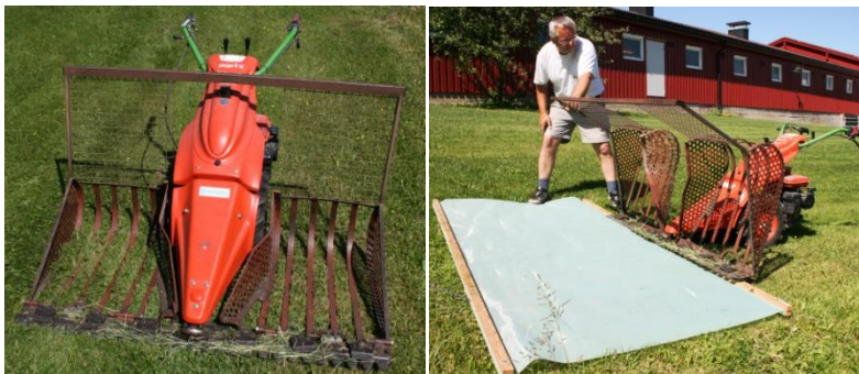
Agria 3600 med grasoppsamler. Roger Kollstuen fra Romerike Landbruksrådgiving demonstrerer tømning på veieseil.
