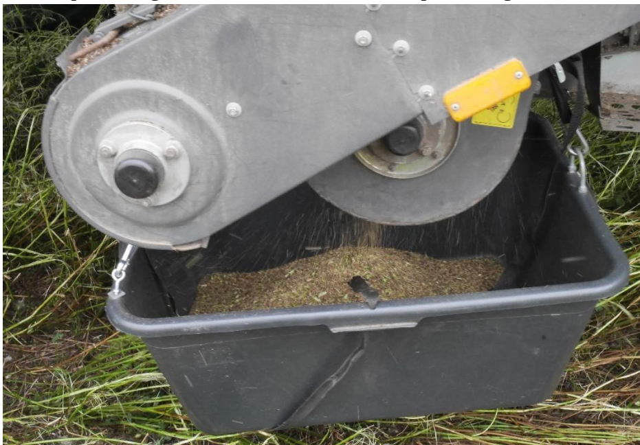
Bilde 11. Storskala høsteforsøk i rødkløver hvor frøet samles i balje i utløpet av bunnskruen.
