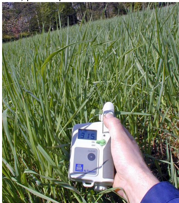
Bilde 6. Ved bruk av Yara N-Tester skal målingene foretas midt på det siste fullt utvikla bladet.
