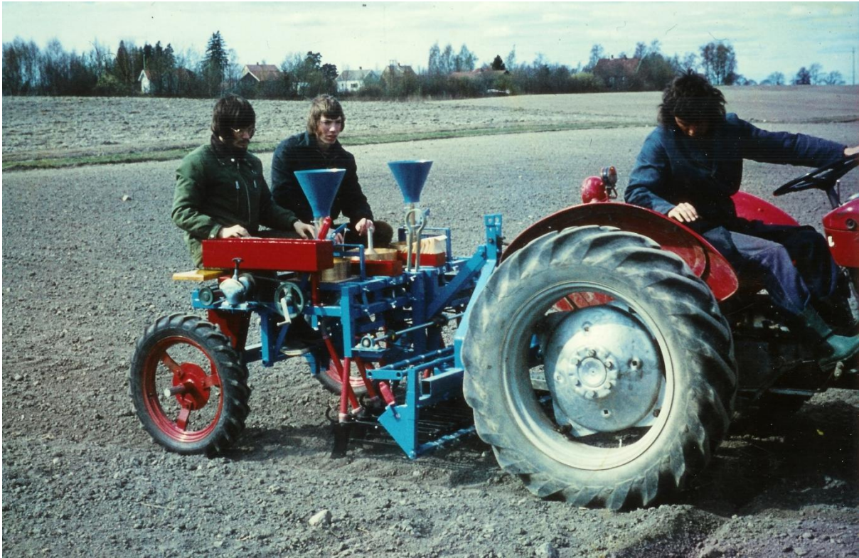
Bilde 11. Øyjords 2x4 raders traktormontert forsøkssåmaskin for dobbelt kapasitet i kornforedlinga, ble konstruert i Øyjords forskningslaboratorium, Jens A. Schou Mek. Verksted, Drøbak i 1974. Bildet er tatt på Institutt for plantekultur, NLH/UMB, Ås. Maskinen er operert av 2 personer, men den kan også opereres av 1 person i tillegg til traktorkjøreren. På såmaskinen Oleif Elen (til venstre) og Jan Stølen. Kjell Jeksrud kjører traktoren.
