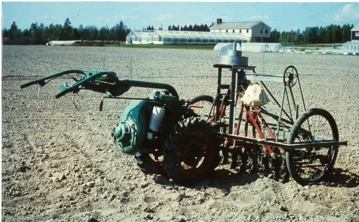
Bilde 4. Øyjords forsøkssåmaskin, modell 1959/60, med 10 rader. Bildet er tatt foran det nedlagte Institutt for genetikk og planteforedling, Norderås, Norges Landbrukshøgskole på Ås våren 1961. Det ble bygget flere serier av denne maskinen. Norsk Landbruksmuseum har fått en slik maskin til sin samling av historisk utstyr.
