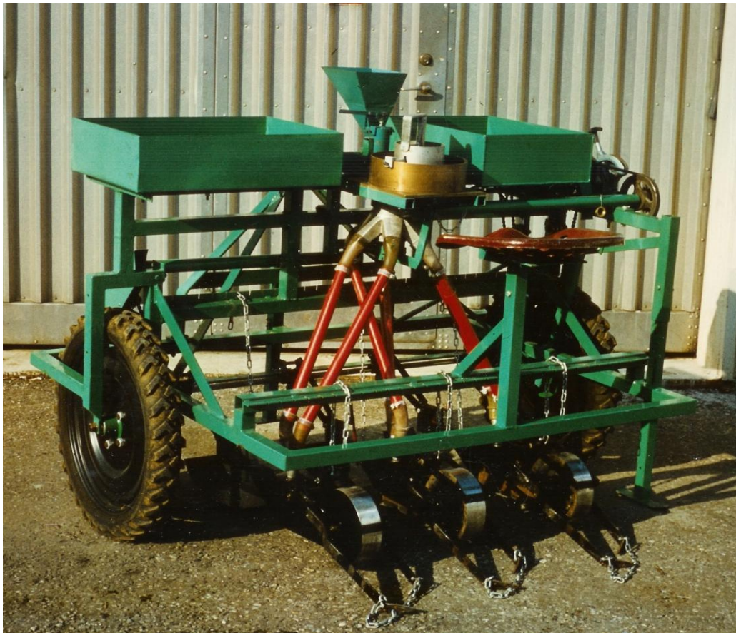
Bilde 10. Øyjords lettbygde forsøkssåmaskin, modell 1979, for montering på 4-hjulstraktor.
