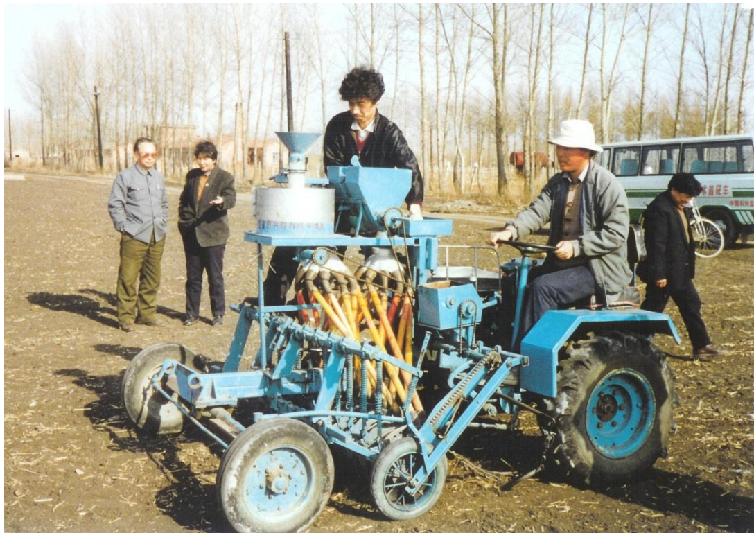
Bilde 26. Bilde fra Nord-Kina 1993. Kinesisk modell av en Øyjords forsøkssåmaskin, montert på en kinesisk traktor. Da hadde Kina laget nesten 100 maskiner, både selvgående og traktormonterte etter modell av Øyjord.
