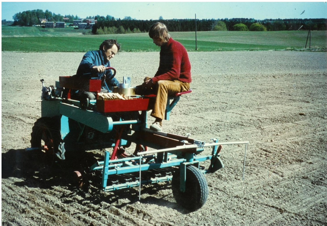
Bilde 20. Bildet viser såing av forsøksfelt for kornforedling på Vollebekk forsøksgård, Institutt for plantekultur, Norges Landbrukshøgskole (NLH) på Ås i 1972 med Øyjords 10- raders selvgående forsøkssåmaskin 1970 modell. Markus Sørensen ved rattet og Jan Stølen administrerer posene.
