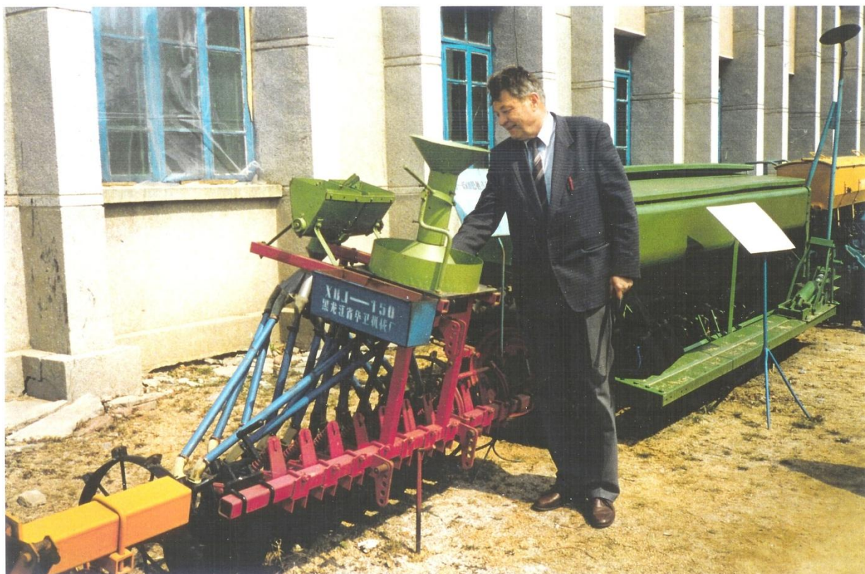
Bilde 13. Egil Øyjord foran en kinesisk utgave av Øyjords forsøkssåmaskin for traktormontering. Fra Hailongjiang Province, Nordøst i Kina, 1993.
