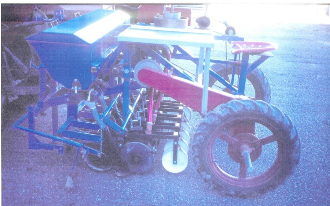
Bilde 17. Øyjords traktormonterte forsøkssåmaskin for porsjonssåing av frø og radsåing av gjødsel, utstyrt med Fiona gjødselingskasse.
