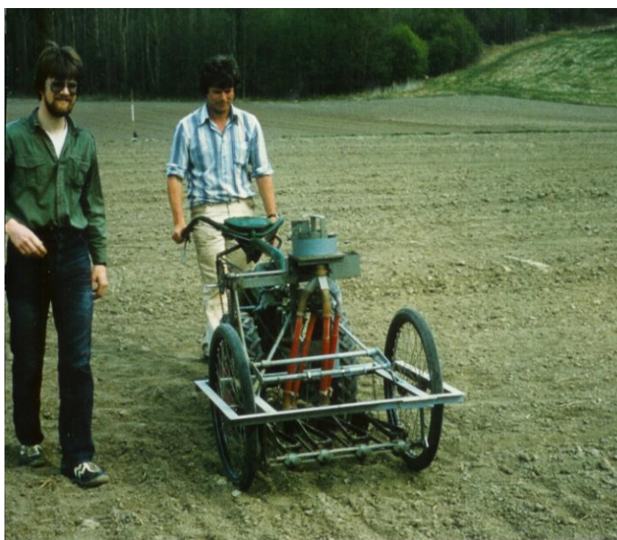
Bilde 5. Øyjords 4-rads forsøkssåmaskin, modell 1960. Institutt for genetikk og planteforedling fikk denne maskina våren 1961. Bilde er fra 1980 tallet. Jon Ostad kjører maskinen, medhjelper er Odd Arne Rognli.
